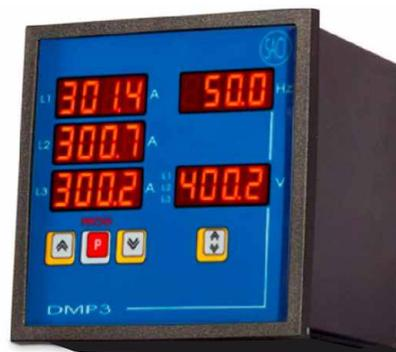
El indicador múltiple DMP3 es un medidor con entradas de tensión y corriente diseñado para la representación de la FRECUENCIA, las CORRIENTES y TENSIONES de una red trifásica, con o sin neutro, mediante la conexión a transformadores de intensidad. Permite la visualización simultánea de tres corrientes, una tensión seleccionable y la frecuencia.
